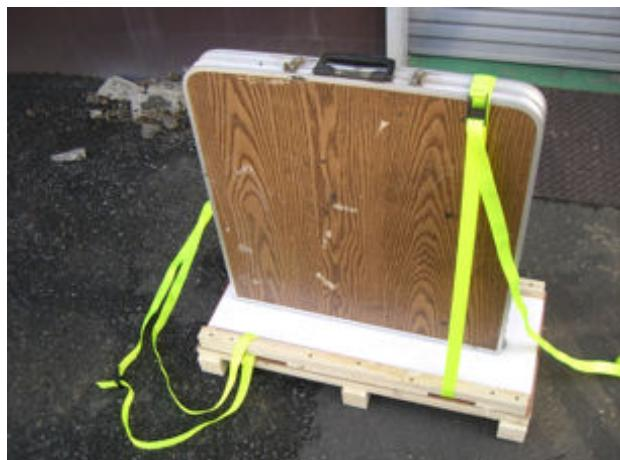
(6) 緩衝材を敷きましたら製品を載せ、ベルトをかけ、固定してください。
