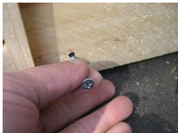
(9) 側面に●印をつけておいたので、その印の場所に木ねじを打ち、上箱を固定したら完成です。
