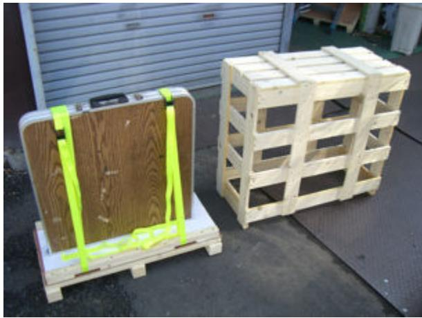
(7) ベルトで製品を固定したら、最初に外した上箱の木箱を上からかぶせます。
